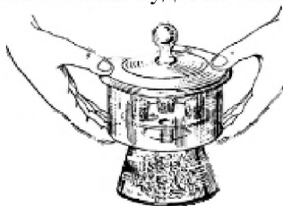
Рис. 2. Правильное положение рук при переносе эксикатора
