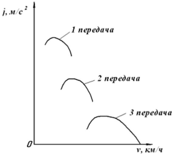
Рис. 3. Графики зависимости ускорения автомобиля от скорости
