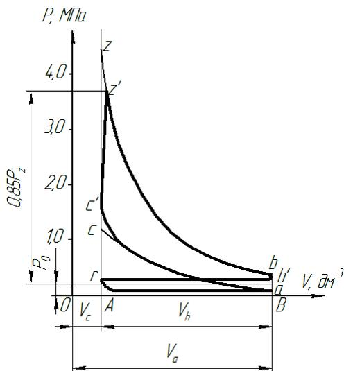
Рис. 3.1. Индикаторная диаграмма четырехтактного двигателя с искровым зажиганием
