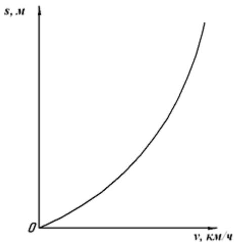
Рис. 6. График зависимости пути разгона автомобиля от скорости
