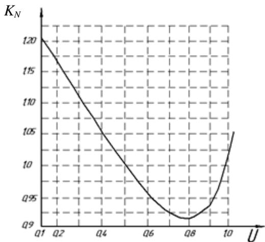
Рис. 9. График зависимости коэффициента  $\kappa_N$  от степени использования мощности двигателя (дизельные двигатели)
