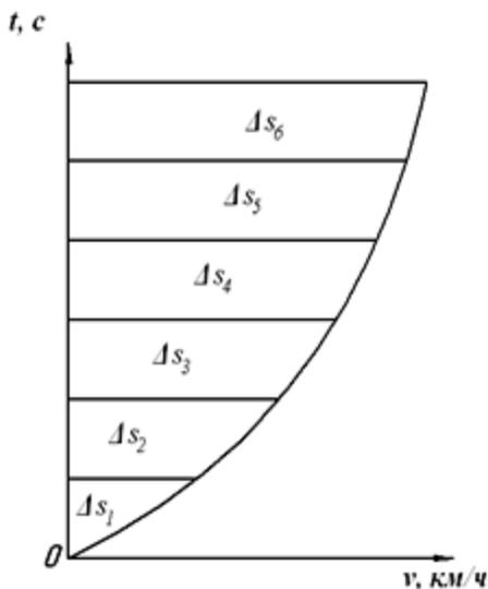
Рис. 5. График зависимости времени разгона автомобиля от скорости
