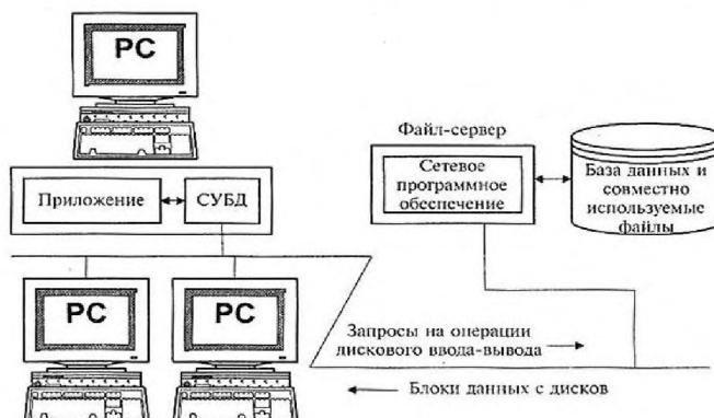
Рис. 8 Принципиальная схема работы системы «файл-сервер»
