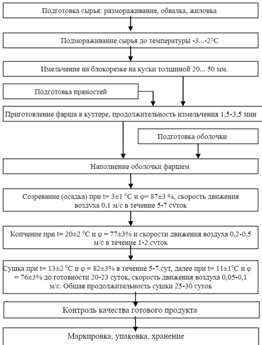
Рис. 2. Технологическая схема производства сырокопченой колбасы «Зернистая»
