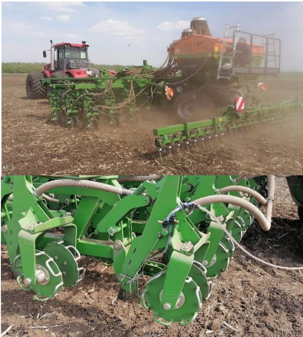
Рис. 2 Полевые испытания установки на сошник
