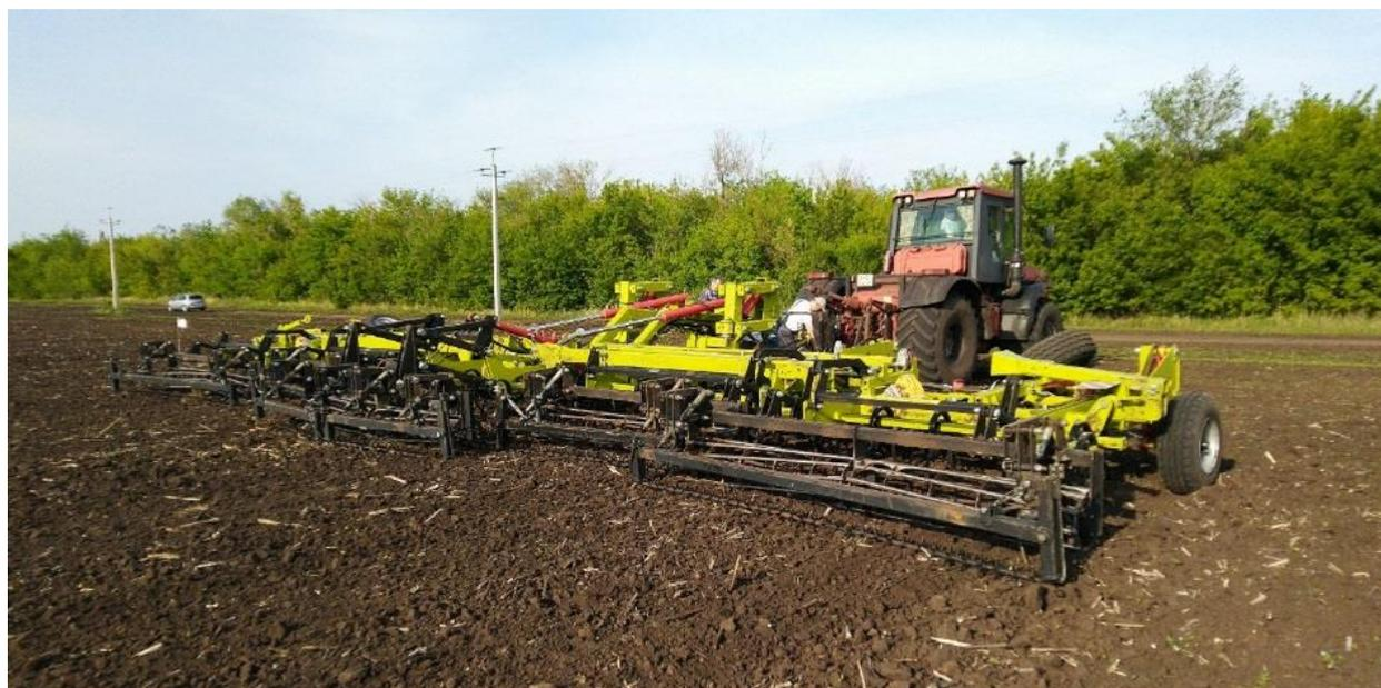
Рисунок 1. Культиватор модульный прицепной КМП-14 в работе в агрегате с трактором К-744Р1.
