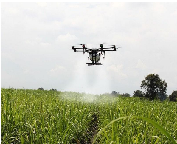
Рис. 2. – Внесение удобрений и химическая защита растений при помощи БПЛА
