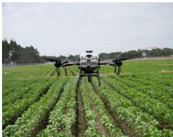
Рис. 2. – Внесение удобрений и химическая защита растений при помощи БПЛА
