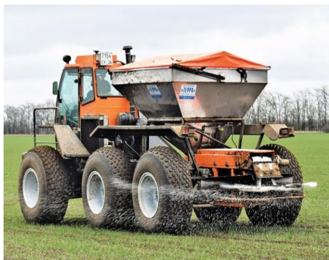
Рис. 1. Агрегаты ООО «Пегас-Агро» применяемые для внесения инновационных минеральных удобрений
