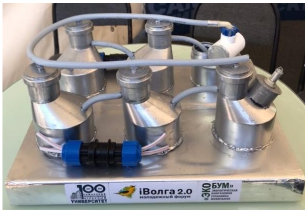
Макет мобильной биогазовой установки
