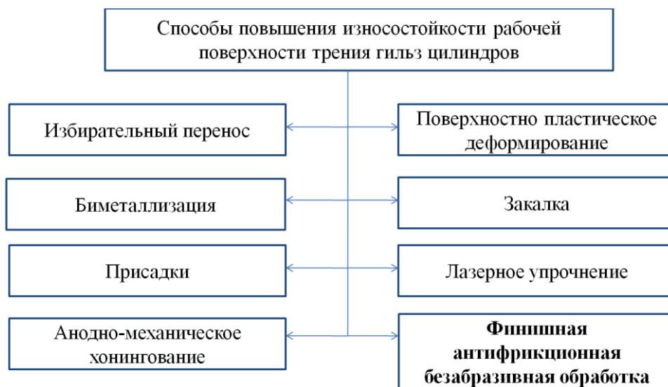
Рис. 3 – Способы повышения износостойкости рабочей поверхности трения гильз цилиндров.
