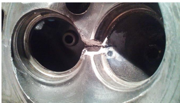
Рис. 1. Трещина межклапанных перемычек
