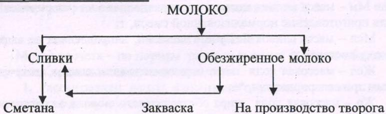
Рис. 3. Схема переработки молока
