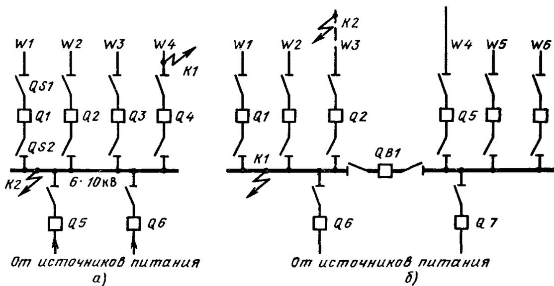
Рис. 1.2. Схемы с одной системой сборных шин
