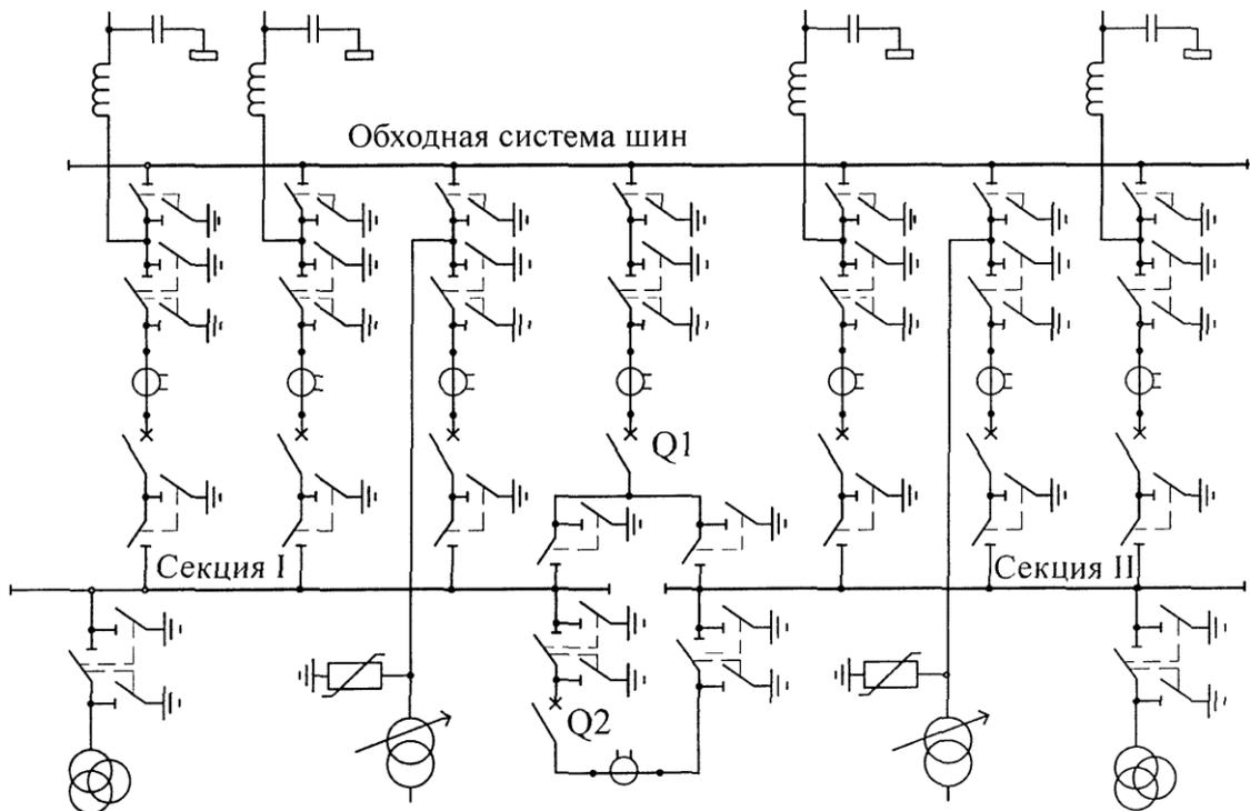
Рис. 1.4. Схема с одной секционированной и обходной системами шин с обходным Q1 и секционным Q2 выключателями
