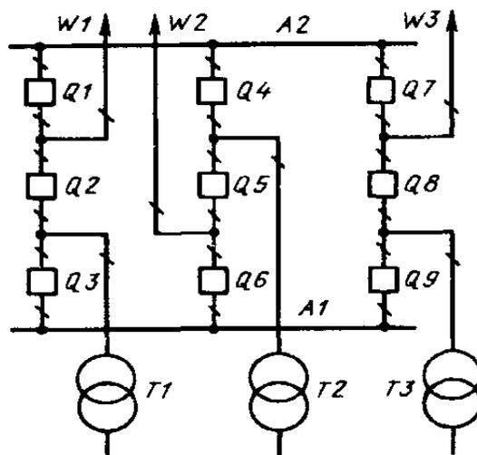
Рис. 1.9. Схема с 3 выключателями на 2 присоединения
