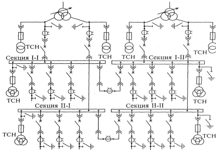
Рис. 1.3. Схема с двумя одиночными секционированными системами шин
