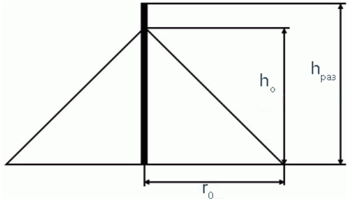
Рис. 2.2. Зона защиты молниеотвода
