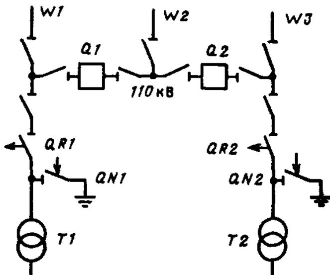
Рис. 1.6. Схема мостика с отделителями в цепях трансформаторов и дополнительной линией
