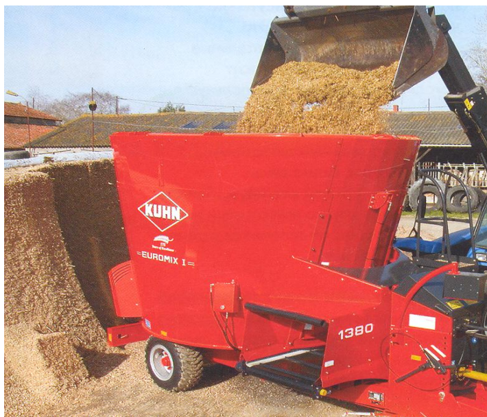
Рис. 18. Загрузка сенажа в мобильный кормораздатчик-смеситель
