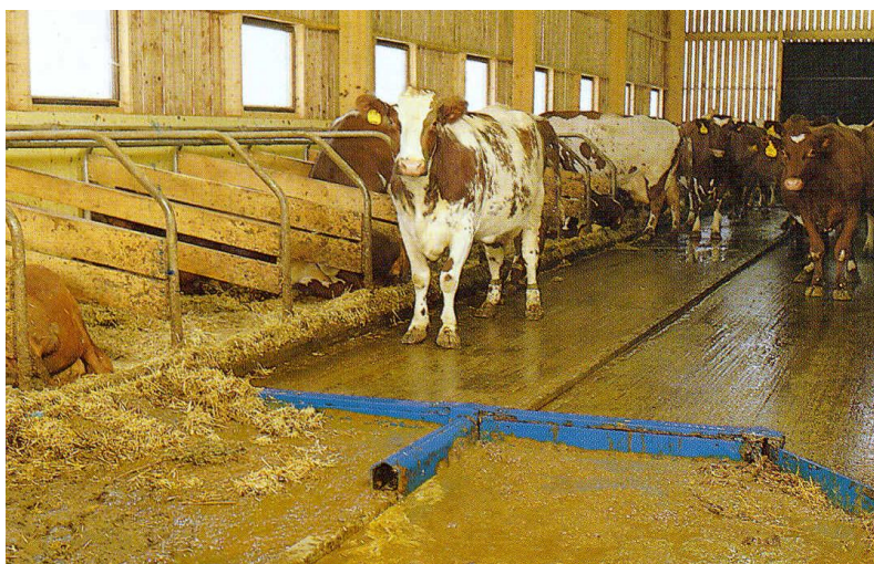
Рис. 36. Уборка навоза при помощи дельта-скрепера
