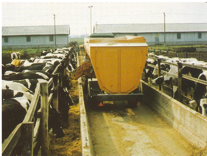
Рис. 19. Кормление коров мобильным кормораздатчиком-смесителем на выгульной площадке
