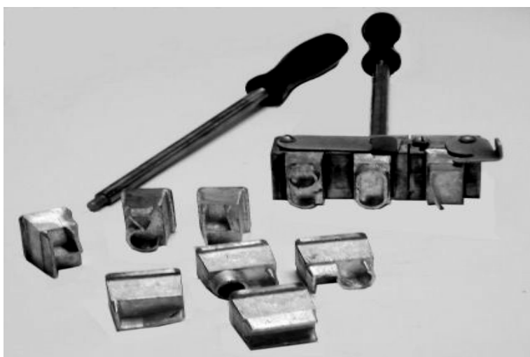
Рис. 5. Приспособление для выжигания номера жидким азотом
