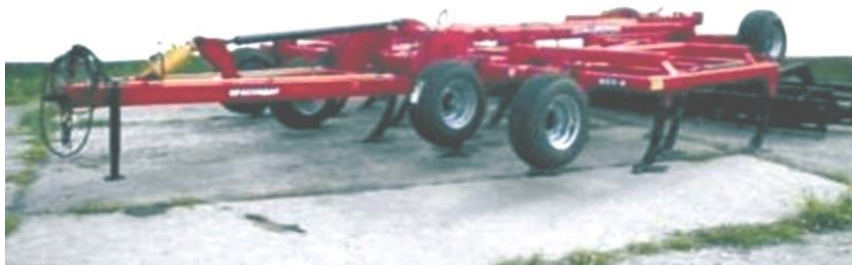
Рис. П. 2.7. Культиватор стерневой универсальный КСУ-6 ООО «БДМ-Агро», г. Краснодар
