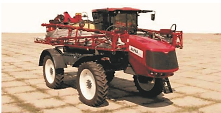
Рис. П. 2.21. Самоходный опрыскиватель HARDIALPHAEVO 4100 (ООО «ЕМС», г. Волгоград)
