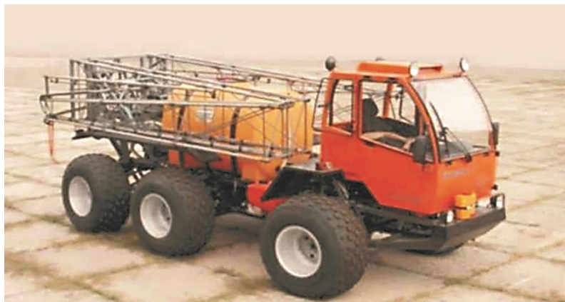
Рис. П. 2.22. Самоходный опрыскиватель ТУМАН-2 (ООО «Пегас-Агро»Самарская обл., Волжский р-н, п.г.т. Стройкерамика)
