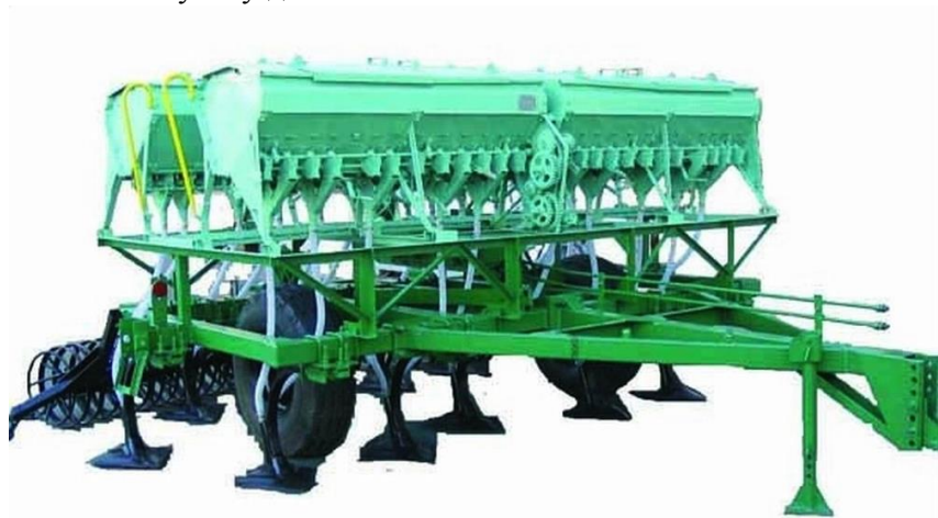
Рис. П. 2.15. Почвообрабатывающая посевная машина «Обь-4-3-3Т» (ОАО Сибирский агропромышленный дом, Новосибирская область, п. Краснообск)
