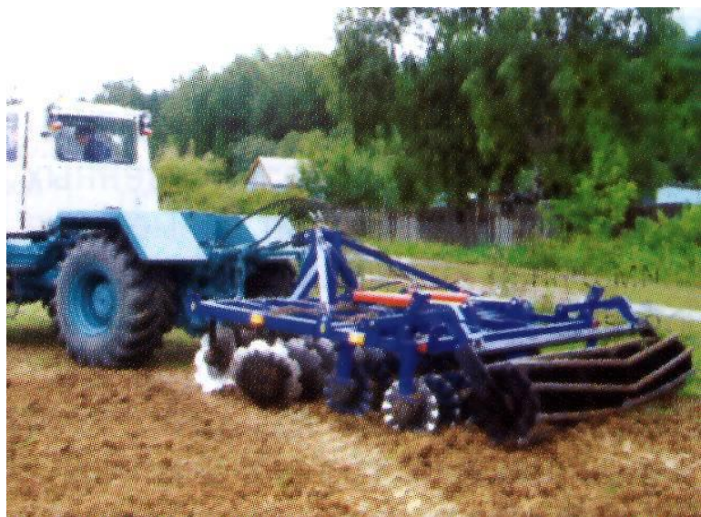
Рис. 21. Агрегат дисковый комбинированный ДАКТ-3,3Н – с дисками и турбодисками
