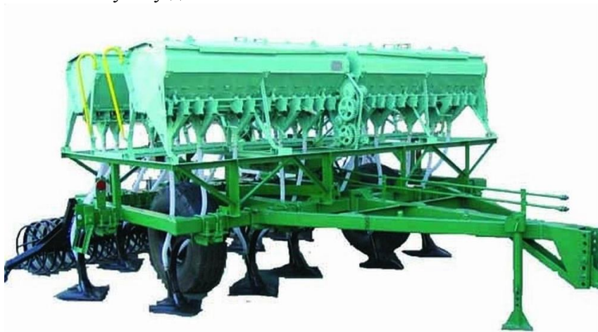
Рис. П. 2.15. Почвообрабатывающая посевная машина «Обь-4-3-ЗТ» (ОАО Сибирский агропромышленный дом, Новосибирская область, п. Краснообск)
