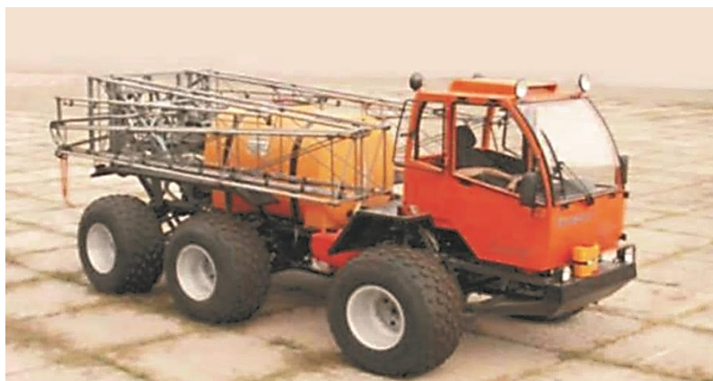
Рис. П. 2.22. Самоходный опрыскиватель ТУМАН-2 (ООО «Пегас-Агро»Самарская обл., Волжский р-н, п.г.т. Стройкерамика)
