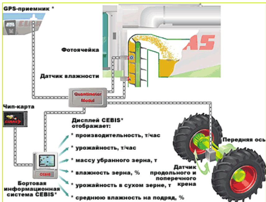
Рис. 33. Схема элементов оборудования для мониторинга урожайности
