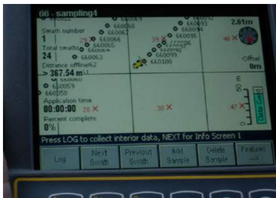
Рис. 30. Отображение маршрута движения автоматизированного комплекса по полю и точки отбора индивидуальных проб с привязкой координат
