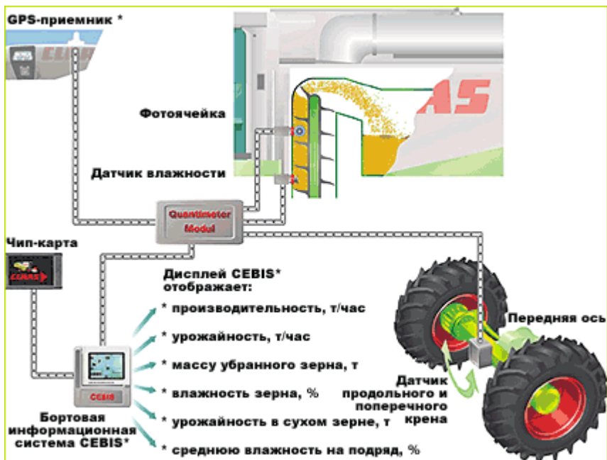
Рис. 33. Схема элементов оборудования для мониторинга урожайности
