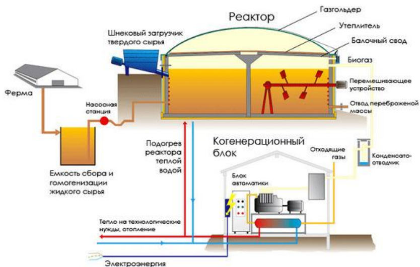
Рис. 5. Схема биогазовой установки
