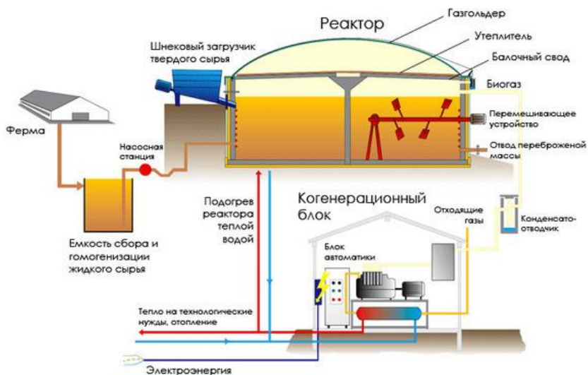
Рис. 5. Схема биогазовой установки
