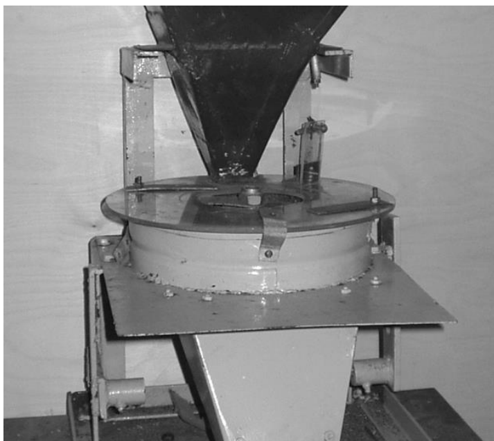
Рис. 10.11. Общий вид высевающего аппарата непрерывного дозирования гравитационного действия
