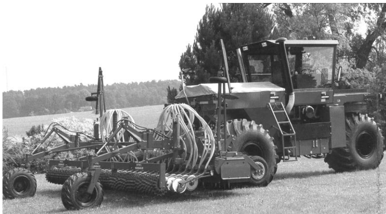
Рис. 9.19. Почвообрабатывающий посевной самоходный комбайн Drill-Exaktor DE 4/5/6 фирмы HORSCH Maschinen
