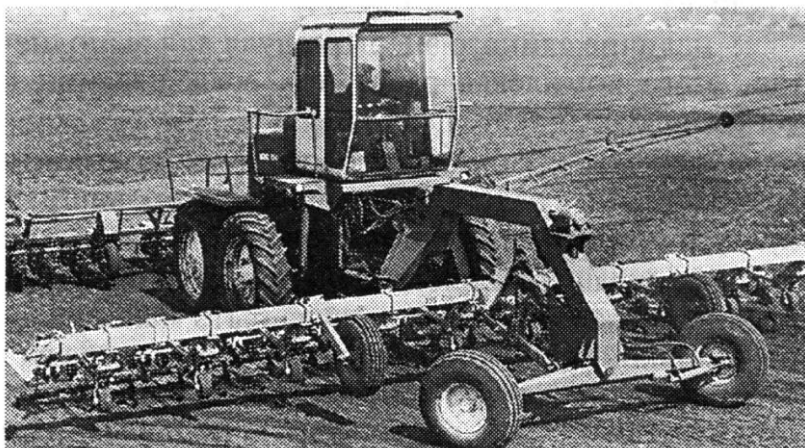
Рис. 9.21. Комбинированный 18-рядный агрегат на базе ВЭС-150 для подготовки почвы и посева сахарной свеклы по уширенной технологической колее
