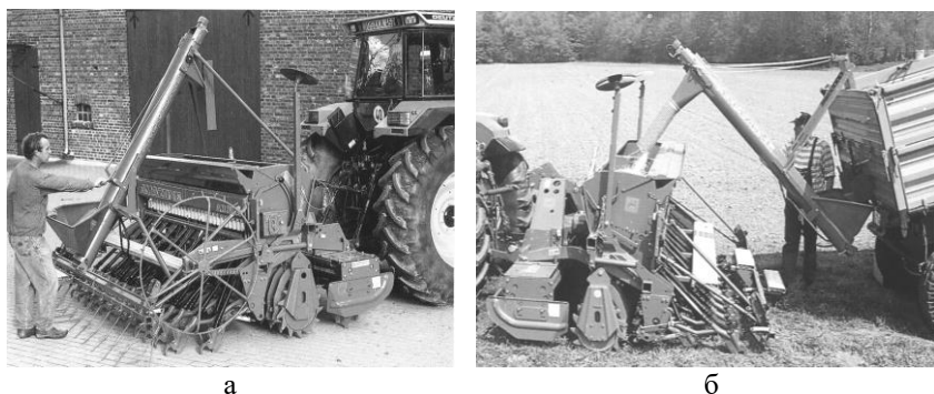
Рис. 7.3. Заправка сеялок: а – загрузчиком, установленным на сеялке; б – загрузчиком, смонтированным на шасси автомобиля
