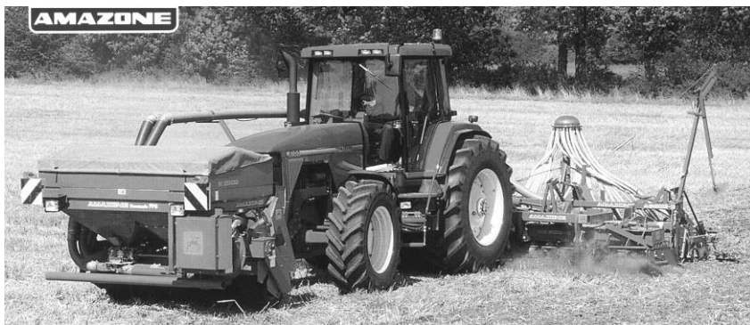
Рис. 9.5. Широкозахватный комбинированный агрегат фирмы «Амазонен Верке» с выносным бункером на передней навеске трактора
