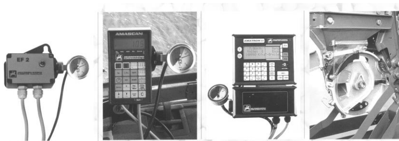
Рис. 6.3. Система контроля качества высева сеялок серии ED фирм «Амазонен Верке» и «Евротехника»
