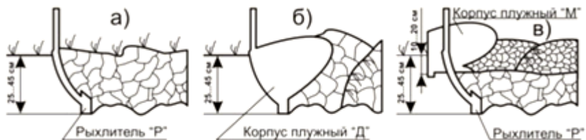
Рис. 13. Схемы обработки почвы с различными типами рабочих органов
