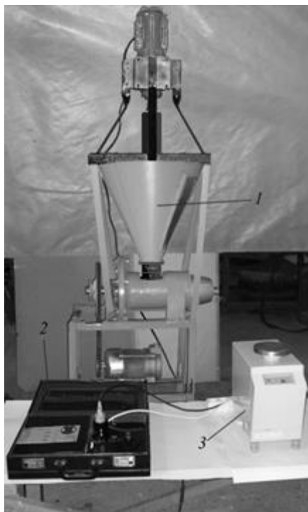
Рис. 2. Общий вид лабораторной установки: 1 – дозатор; 2 – блок управления; 3 – лабораторные весы
