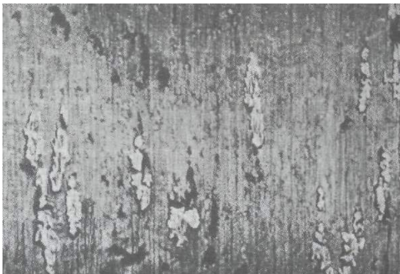
Рис. 5.8. Частицы чугуна на рабочей поверхности тормозной колодки легкового автомобиля
