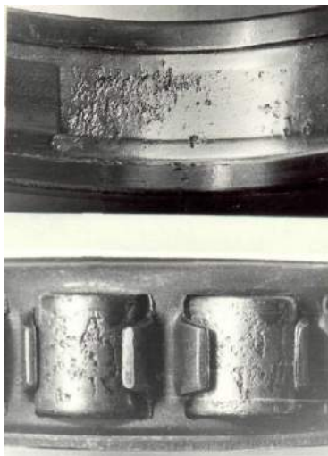
Рис. 5.2. Роликовый подшипник качения, изношенный питтингом
