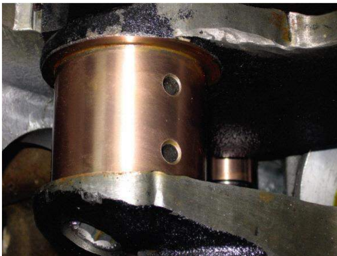
Рис. 18.3. Шатунная шейка, подвергнутая ФАБО
