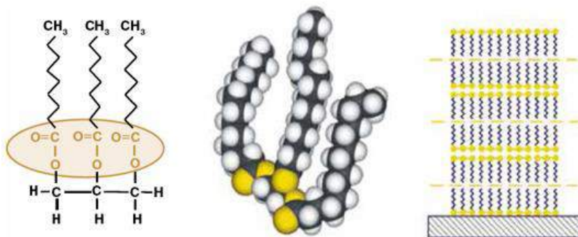
Рис. 13.1. Структура, трехмерная модель и схема ориентации молекул триглицерида на поверхности металла
