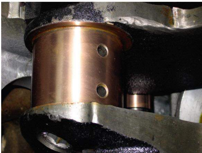
Рис. 18.3. Шатунная шейка, подвергнутая ФАБО
