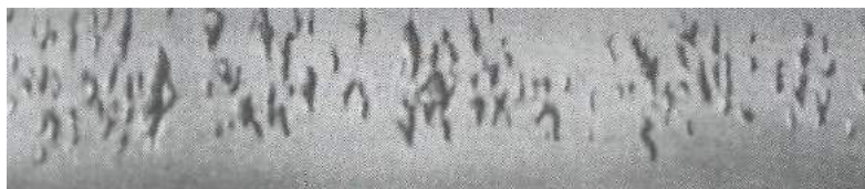
Рис. 5.7. Поверхность поршневого кольца двигателя, пораженная эрозией
