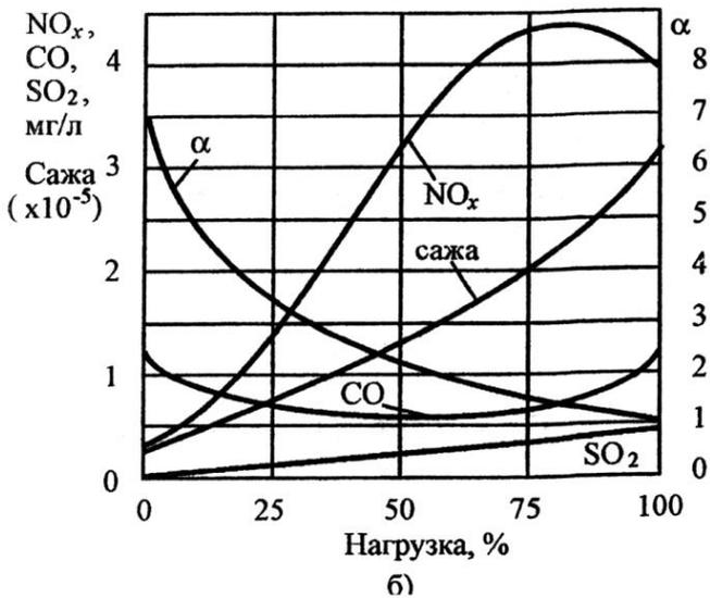
Рис. 10.1 Нагрузочная токсическая характеристика двигателя:
