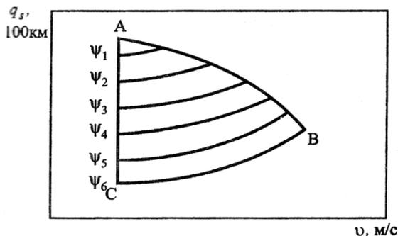
Рис. 9.1 Экономическая характеристика автомобиля на высшей передаче в различных дорожных условиях:  $\Psi_1 \dots \Psi_6$  – коэффициенты суммарного сопротивления для различных дорожных условий; А, В, С – точки, соответствующие максимальной скорости движения при полной подаче топлива
