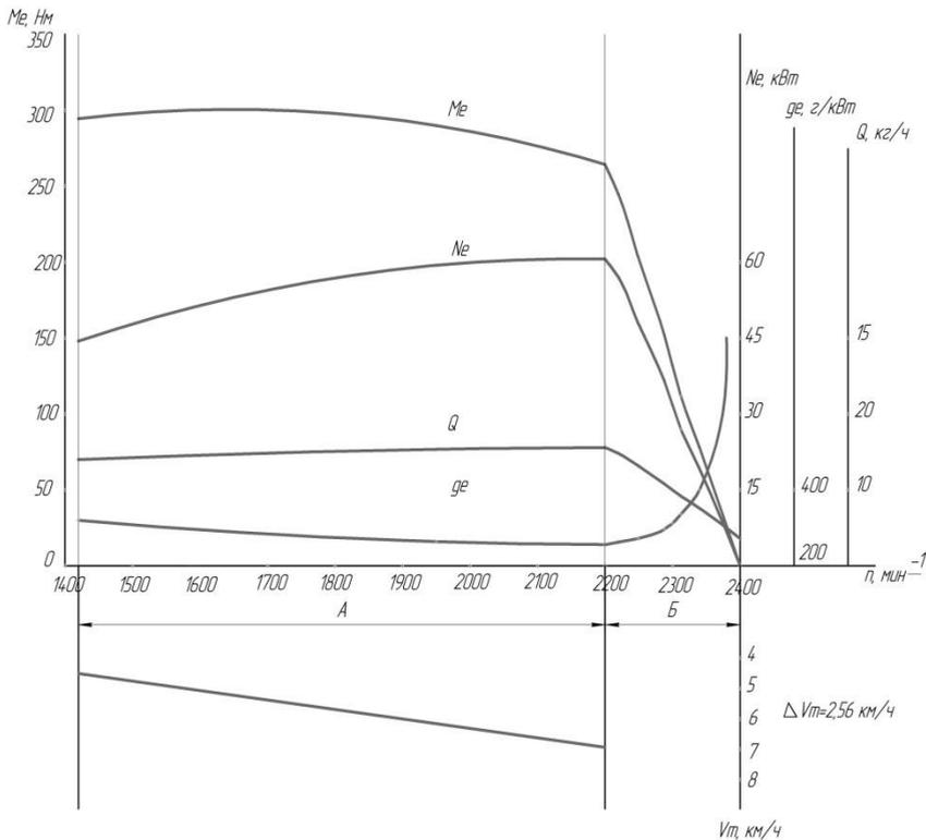
Рис. 2. Регуляторная (скоростная) характеристика тракторного двигателя:
