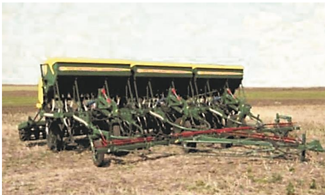
Рис. П. 2.16. Посевной агрегат из 3-х сеялок зерновых стерневых СЗС-2,8 (ОАО «НПО Сибсельмаш», г. Новосибирск)
