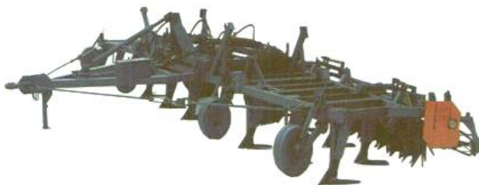
Рис. П. 2.3. Культиватор-плоскорез игольчато-роторный КПИР-7,2 (ООО «Буинский машиностроительный завод», Республика Татарстан)
