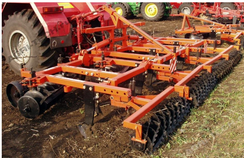
Рис. П. 2.6. Агрегат почвообрабатывающий комбинированный АПК-6 (ОАО «Волгодизельаппарат», г. Маркс, Саратовская область)
