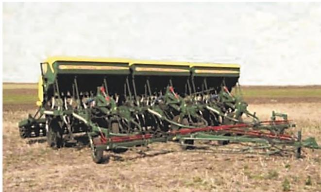
Рис. П. 2.16. Посевной агрегат из 3-х сеялок зерновых стерневых СЗС-2,8
