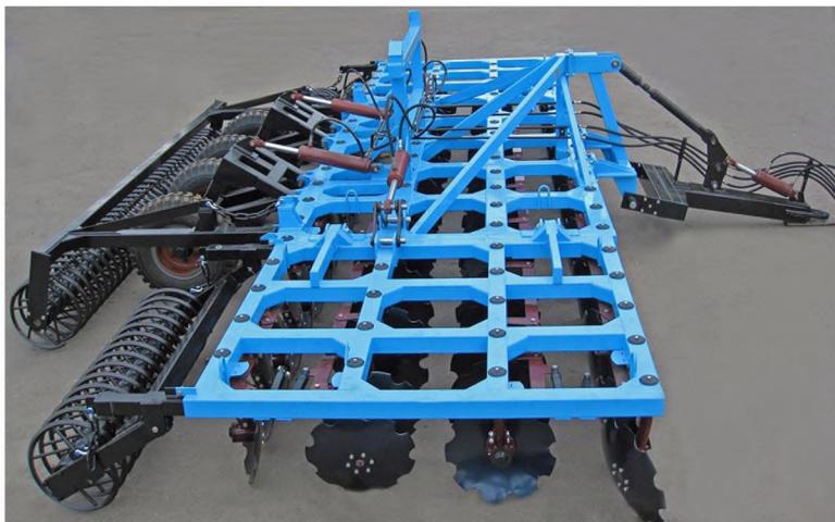
Рис. П. 2.8. Дискатор БДМ-6,6×4ПК
