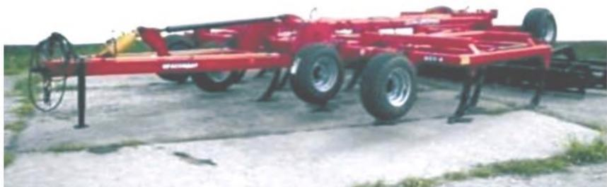
Рис. П. 2.7. Культиватор стерневой универсальный КСУ-6
