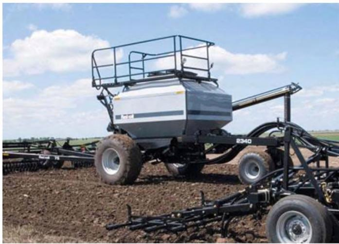
Рис. П. 2.19. Посевной комплекс Flexi-Coil 9,8
