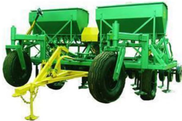
Рис. П. 2.14. Агрегат посевной АУП 18.07
