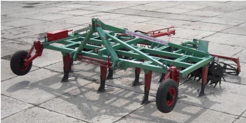
Рис. П. 2.12. Культиватор-плоскорез универсальный КПУ-3,6 (ООО «Буйнский машиностроительный завод», Республика Татарстан)
