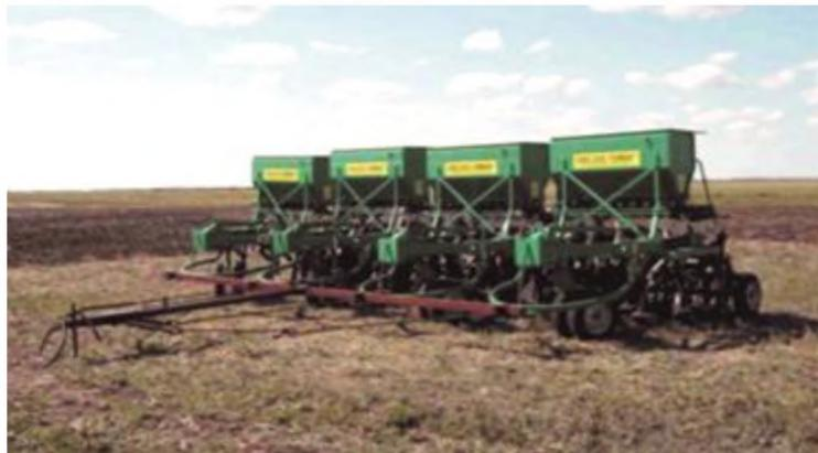
Рис. П. 2.13. Посевной агрегат из четырех сеялок-культиваторов
