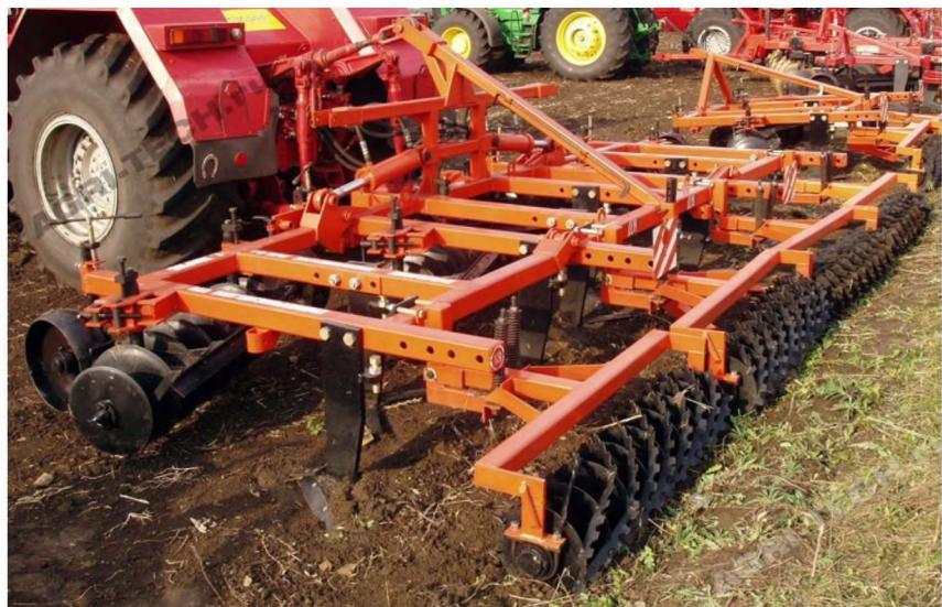
Рис. П. 2.6. Агрегат почвообрабатывающий комбинированный АПК-6
