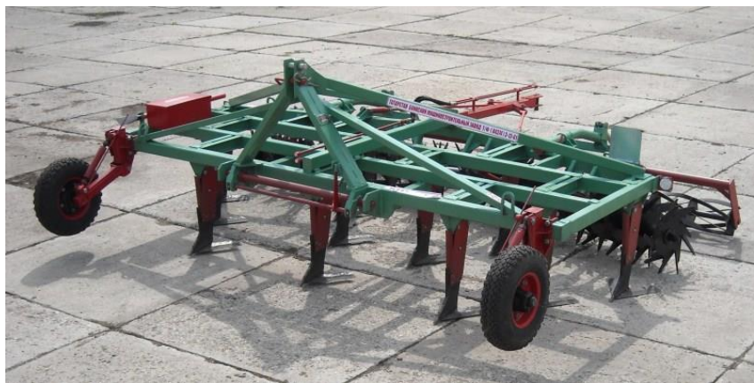
Рис. П. 2.12. Культиватор-плоскорез универсальный КПУ-3,6 (ООО «Буинский машиностроительный завод», Республика Татарстан)
