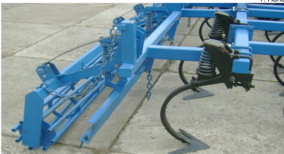
Рабочие органы (стойка с лапой, выравниватель, ротор)
