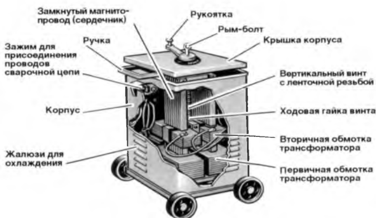
Рис. 9.2. Внешний вид сварочного трансформатора
