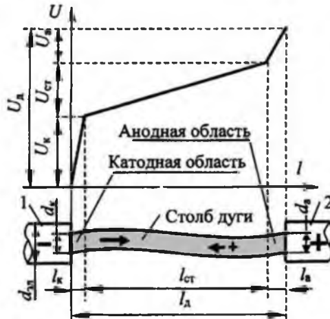
Рис. 10.3. Распределение потенциала по длине дуги
