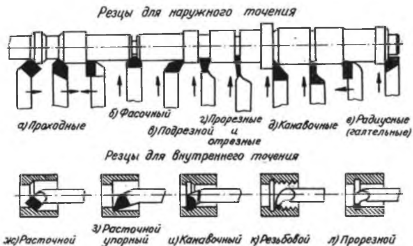
Рис. 11.2. Виды резцов по назначению
