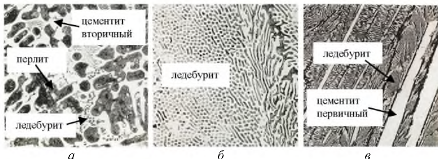
Рис. 5.2. Белый чугун, ув. X100: а – доэвтектический; б – эвтектический; в – заэвтектический
