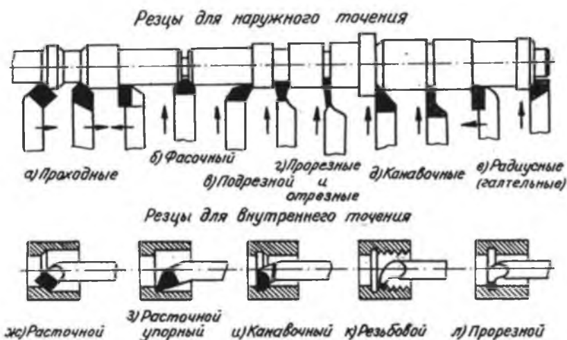
Рис. 11.2. Виды резцов по назначению
