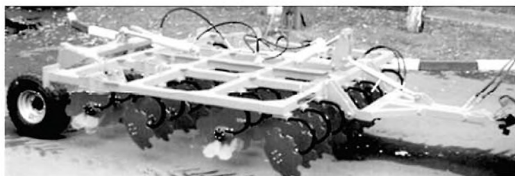
Рис. 32. Дисковый мульчировщик ДМ-3,2
