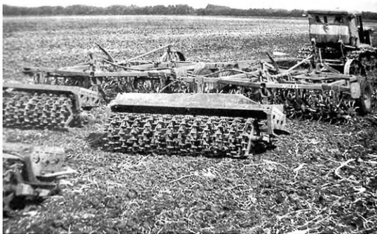
Рис. 30. Кольчато-шпоровый каток ЗКШ-6
