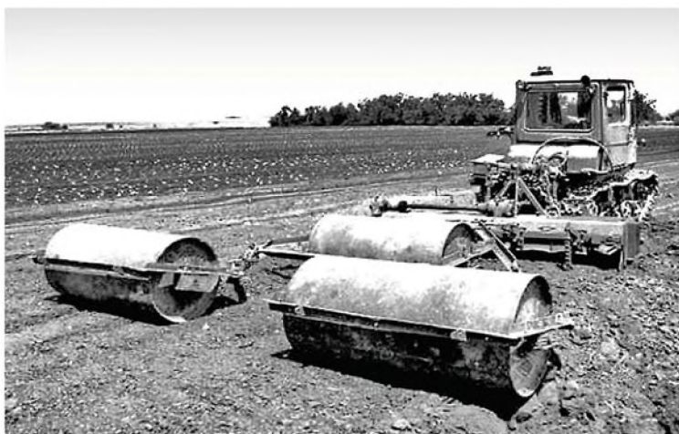
Рис. 29. Водоналивные гладкие катки СКГ-2,1
