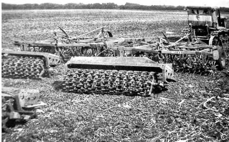
Рис. 30. Кольчато-шпоровый каток ЗКШ-6
