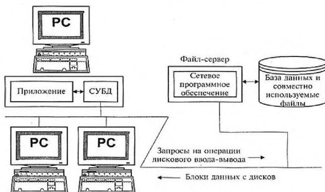
Рис. 8 Принципиальная схема работы системы «файл-сервер»
