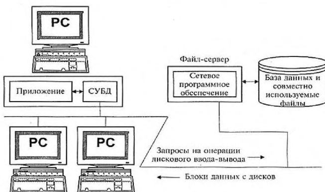
Рис. 8 Принципиальная схема работы системы «файл-сервер»
