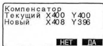
Рис. 18. Новые значения поправок после юстировки
