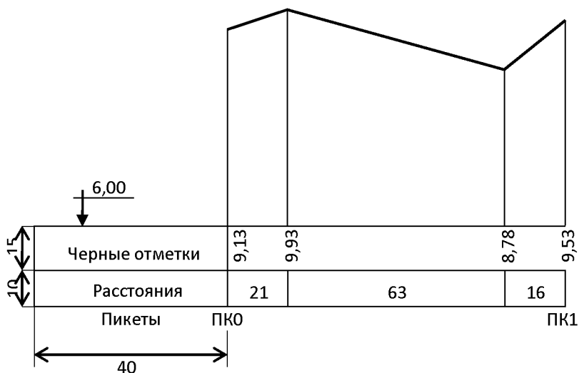
Рис. 10. Продольный профиль трассы
