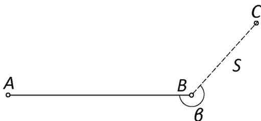
Рис. 2. Восстановление утраченного межевого знака полярным способом
