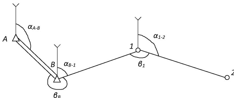
Рис. 4. Привязка съёмочного обоснования к пунктам ГГС
