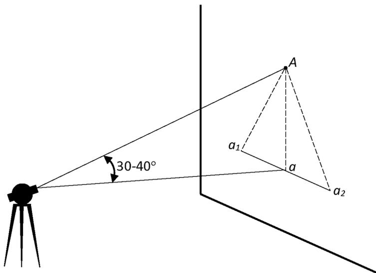
Рис. 3. Проверка перпендикулярности горизонтальной и вертикальной осей теодолита
