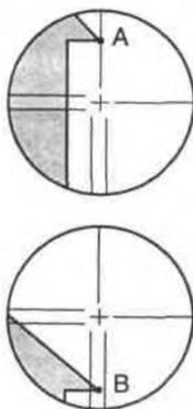
Рис. 21. Проверка перпендикулярности сетки нитей и горизонтальной оси
