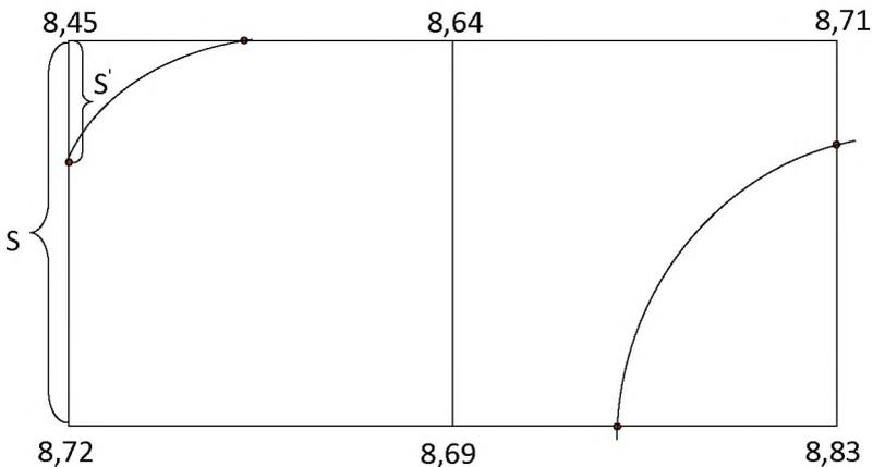
Рис. 12. Проведение горизонталей по результатам нивелирования поверхности по квадратам
