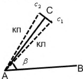
Рис. 10. Вынос в натуру проектного горизонтального угла
