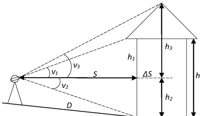
Рис. 12. Схема определения высоты здания при помощи теодолита
