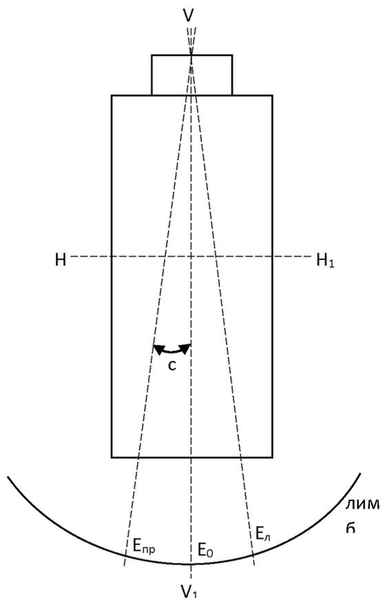
Рис. 2. Проецирование визирной оси на плоскость лимба
