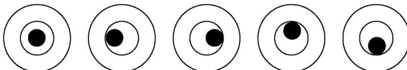
Рис. 8. Положения пузырька круглого уровня при определении погрешности недокомпенсации
