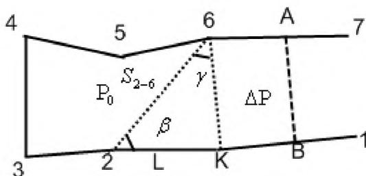
Рис. 8. Проектирование участка линией, параллельной заданному направлению
