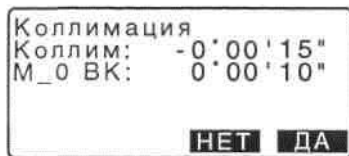
Рис. 19. Определение коллимационной ошибки и места нуля вертикального круга
