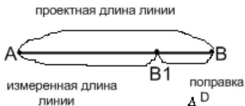
Рис. 9. Вынос в натуру прямой горизонтальной линии
