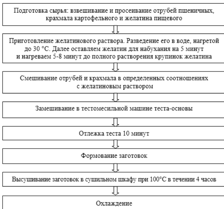
Рис. 1. Технологическая схема производства биоразлагаемой одноразовой упаковки на основе отходов мукомольного производства
