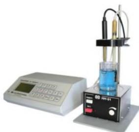
Рис. 24. Устройство для проведения потенциометрических измерений
