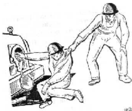
Рис. 3. Освобождение пострадавшего от действия токоведущей части, находящейся под напряжением до 1000 В
