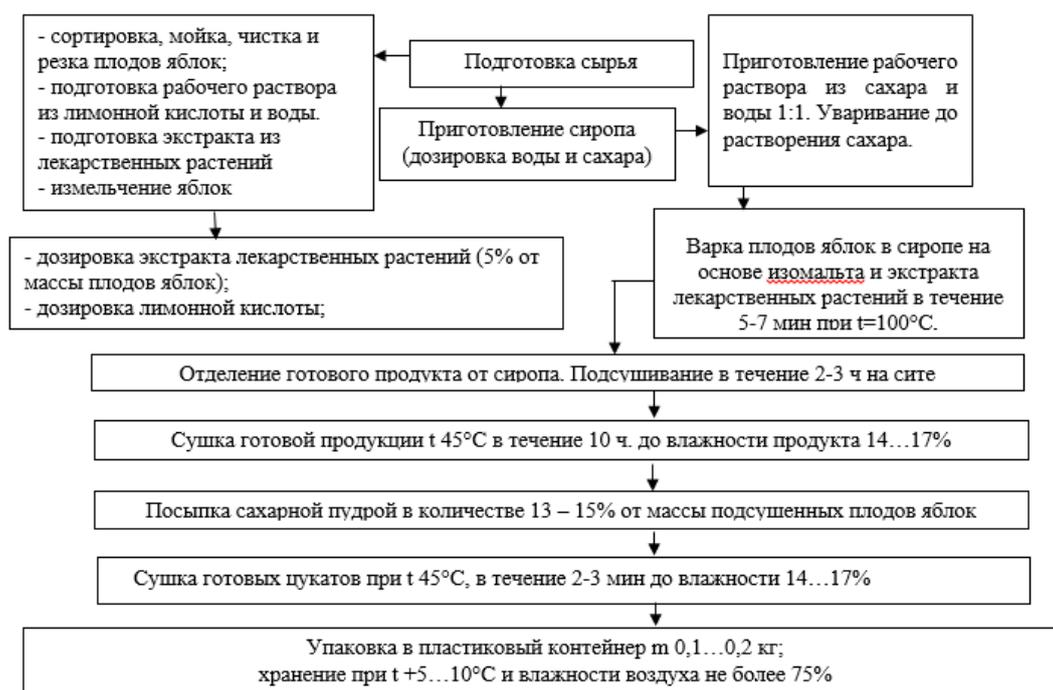
Рис. 2. Предлагаемая технологическая схема производства диабетических цукатов
