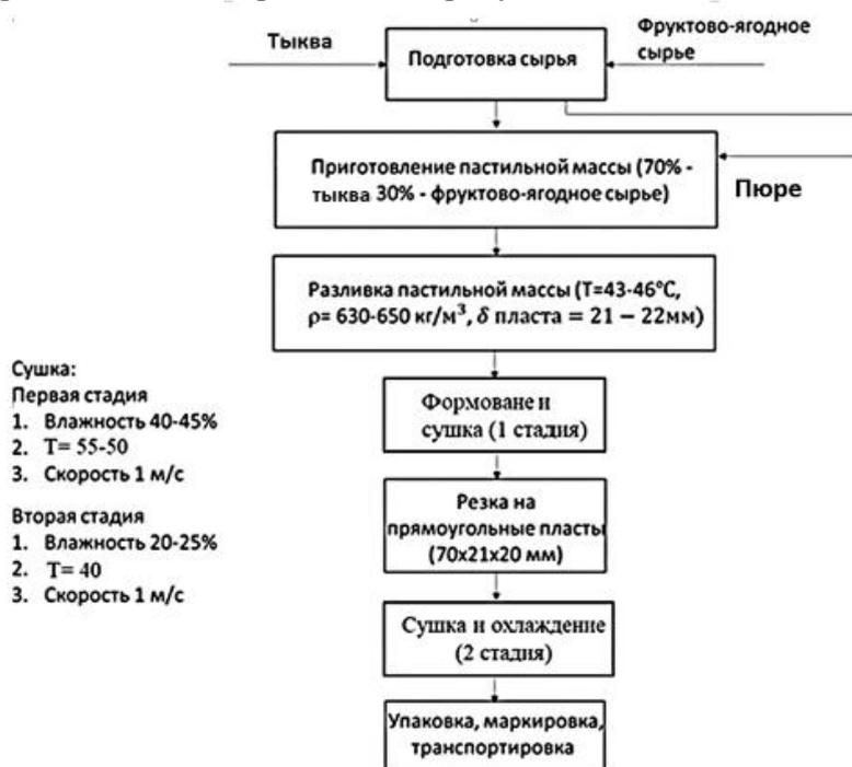
Рис. 2. Предлагаемая технологическая схема производства смоквы из плодов тыквы
