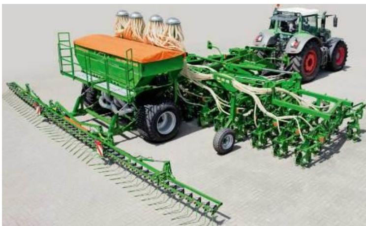
Рис.1. Сеялка для прямого, «мульчирующего» посевов Primer DMC-12000
