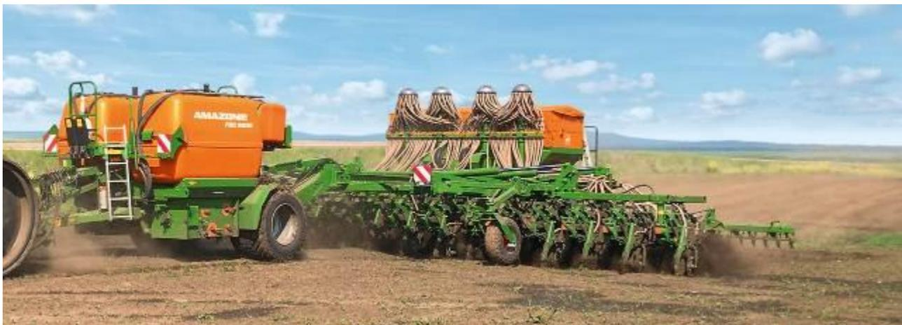
Рис.2. Агрегат для посева сеялкой DMC Primer с внесением жидких удобрений агрегатом FDC
