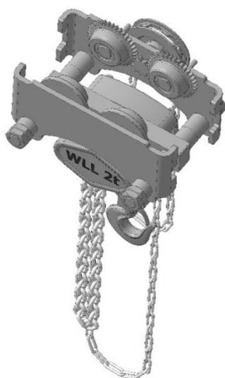
Рис. 4. Таль ручная шестеренная
