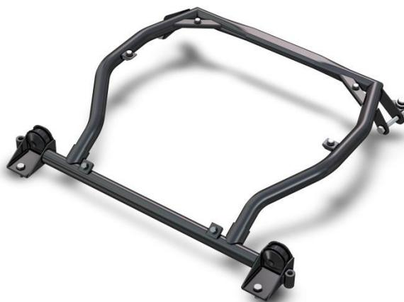
Рисунок 4. Подрамник передней подвески
