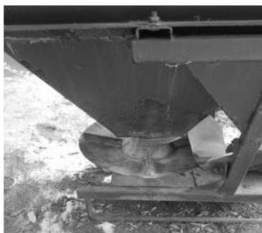
Рис. 3– Коррозионные разрушения разбрасывателей минеральных удобрений
