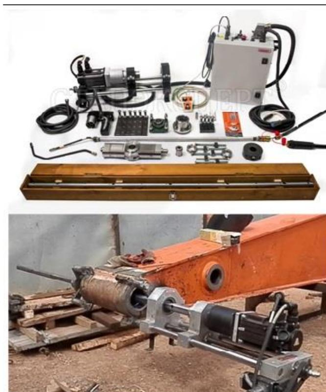
Рис. 2. Мобильный расточно – наплавочный комплекс
