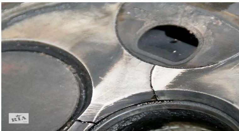
Рис. 1. Трещины межклапанных перемычек
