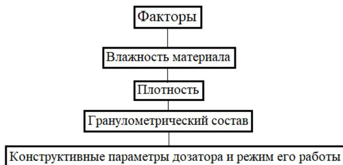
Рис. 2. Факторы, от которых зависит точность и равномерность дозирования
