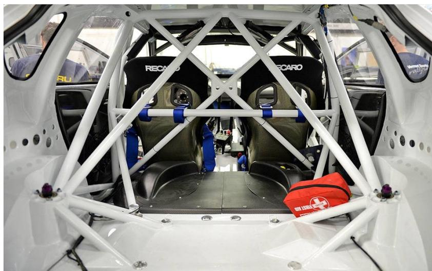
Рисунок 1. Трубчатый каркас безопасности
