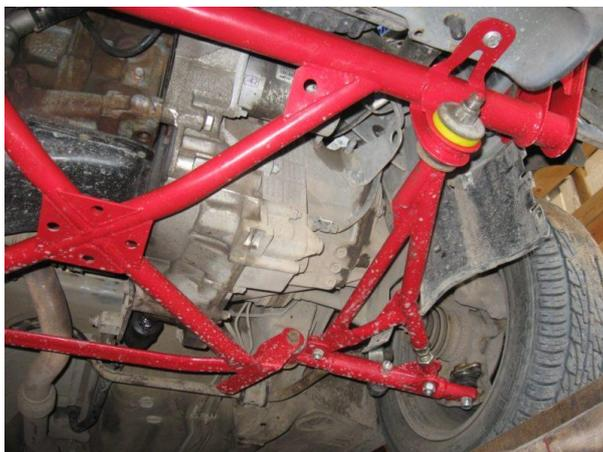
Рисунок 2. Подрамник и треугольные рычаги
