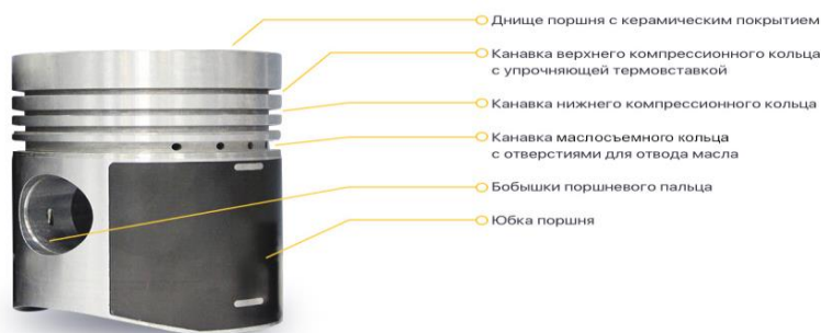
Рис. 1. Конструктивные элементы поршня
