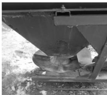
Рис. 3– Коррозионные разрушения разбрасывателей минеральных удобрений
