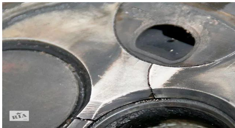
Рис. 1. Трещины межклапанных перемычек
