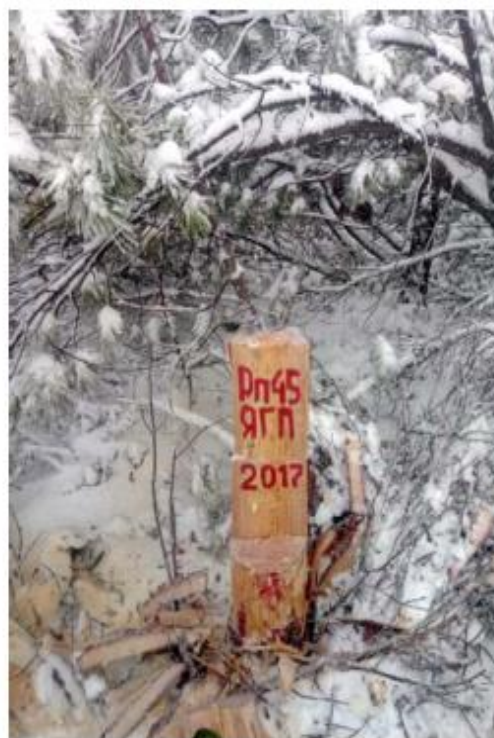
Рис.7 Примеры закрепления реперов
