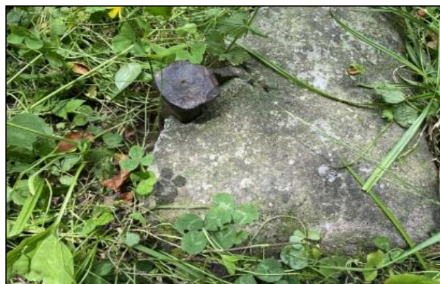
Рис. 2 Положение пункта ГГС «Винокуренный», поиск на местности (а) и оценка состояния центра (б)
