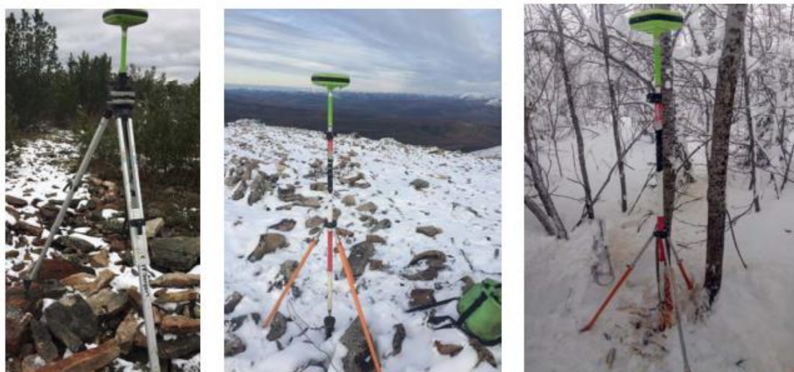
Рис. 2 Создание опорной геодезической сети
