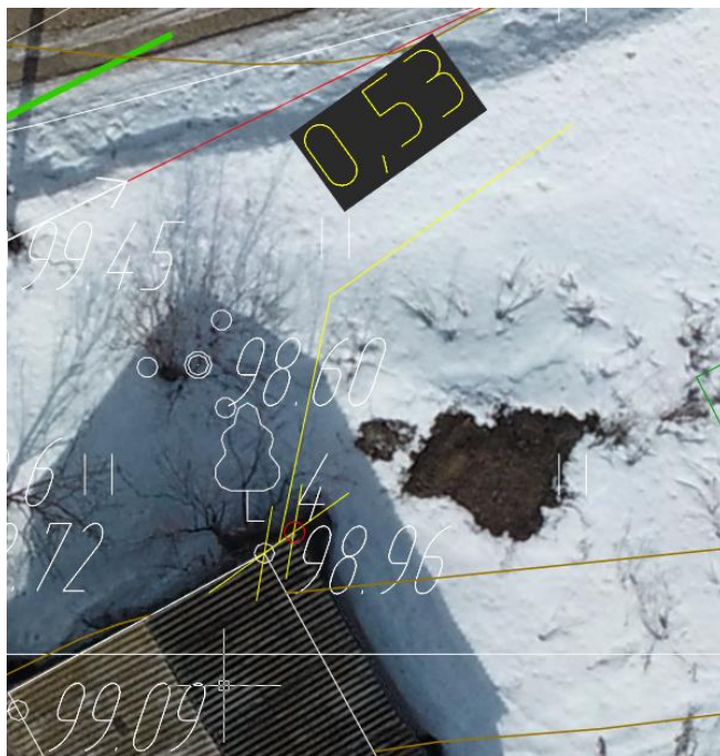
Рис. 2 Погрешность в определении угла здания
