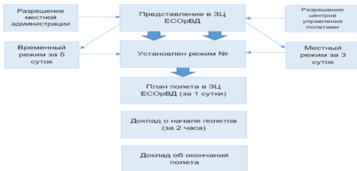
Рис. 2 Структура подачи заявок на получение разрешения использования воздушного пространства
