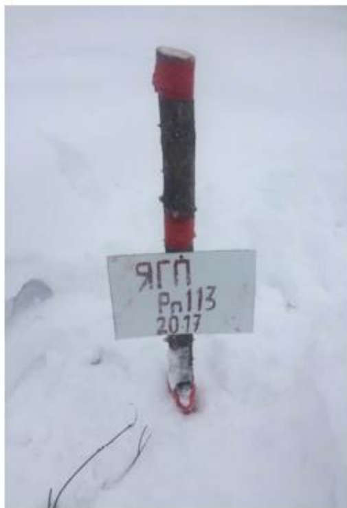
Рис.7 Примеры закрепления реперов
