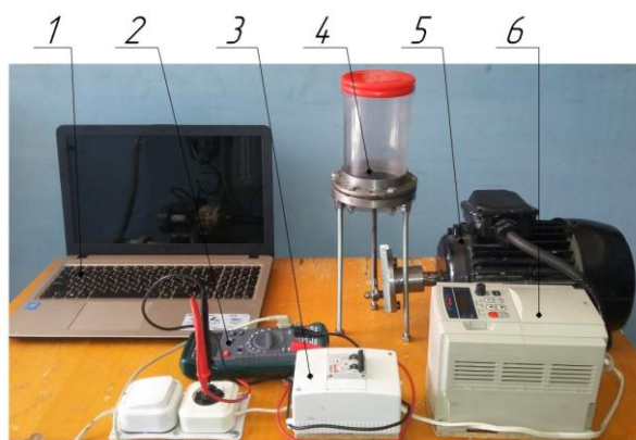
Рис. 1. Общий вид лабораторной установки маслоизготовителя с гибким виброприводом: 1 – ноутбук ASUS; 2 – мультиметр электронный MAS-345; 3 – выключатель автоматический ИЕК; 4 – маслоизготовитель с гибким виброприводом; 5 – электродвигатель АИРЕ 56В4; 6 – преобразователь частоты вращения ВЕСПЕР E2-8300
