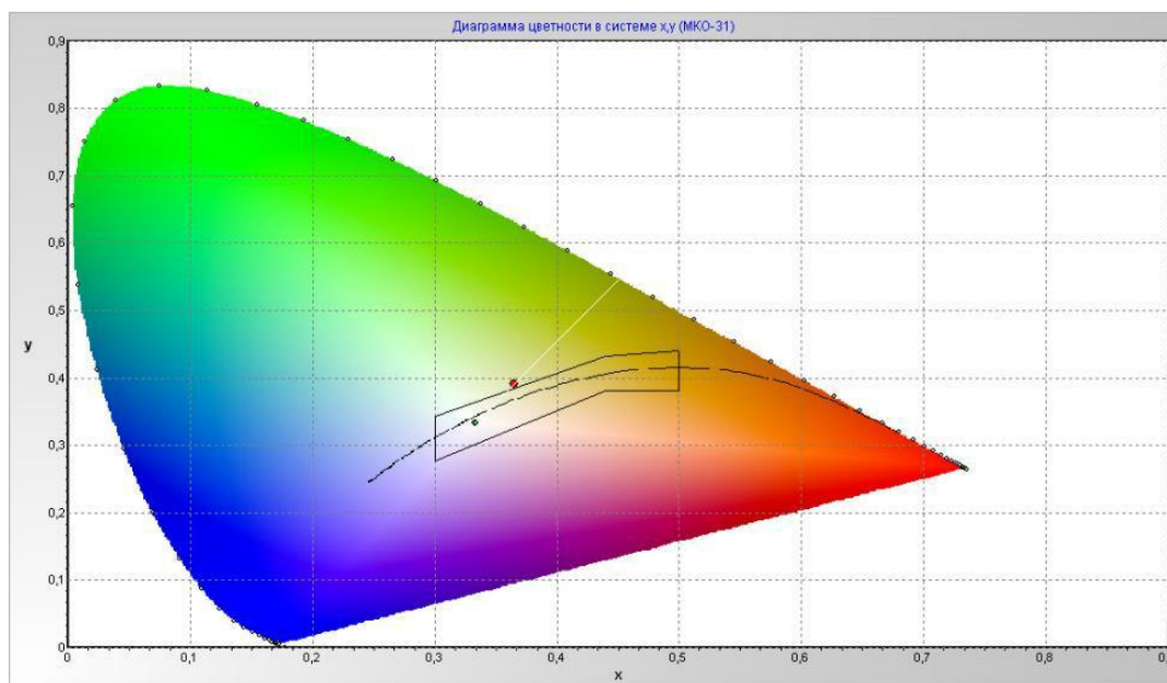
Рис. 2. Диаграмма цветности люминесцентного фитосветильника в системе x, y
