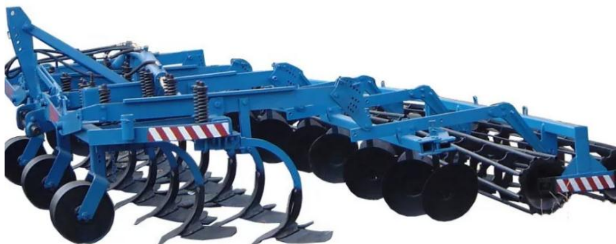
Рис.3. Культиватор навесной КНК-4000
