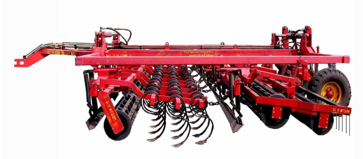
Рис. 2. Культиватор с двумя выравнителями сплошного типа
