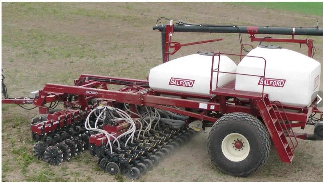
Рис. 3. Посевной комплекс Селфорд 522 с дисковыми сошниками
