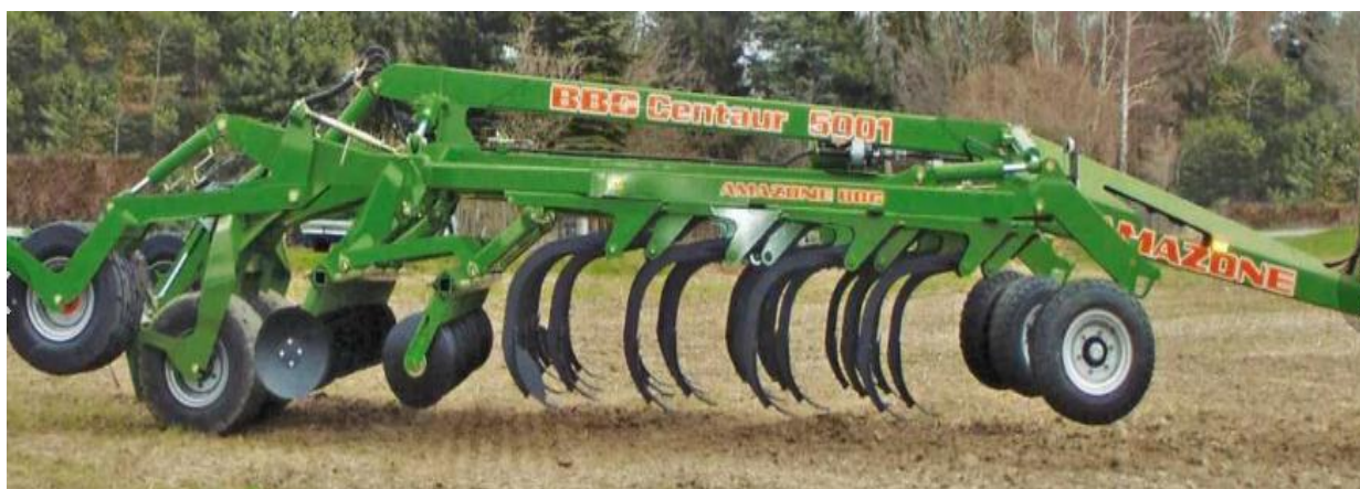
Рис. 2. Культиватор Центаур с С-образными стойками и стреловидными наральниками фирмы Амазоне
