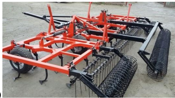
Рис. 3. Культиватор предпосевной КПУ-9: (а) и культиватор с выравнителем секционного типа (б)
