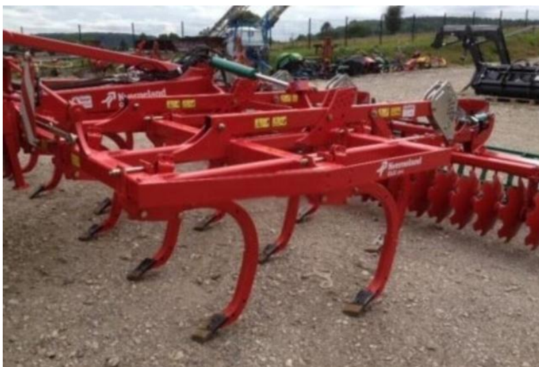
Рис.1. Культиватор с С-образными стойками и долотообразными рабочими органами фирмы Квернеланд
