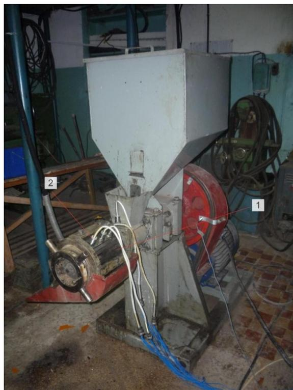
Рис.1. Схема установки датчиков давления в корпусе цилиндра пресса:
