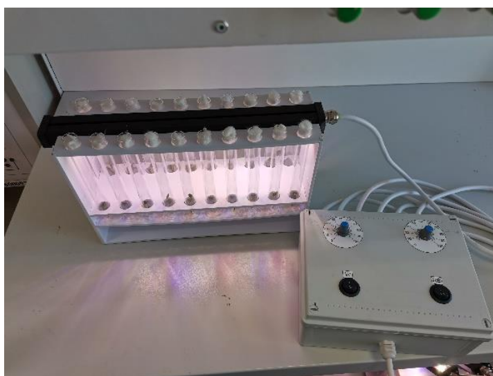
Рис.1. Установка для досвечивания и стимуляции ростков магнитным полем:
