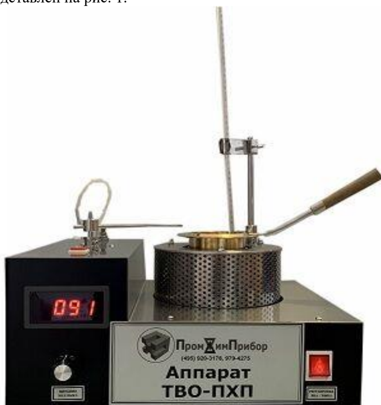
Рис. 1. Аппарат для определения температуры вспышки в открытом тигле по методу Кливленда
