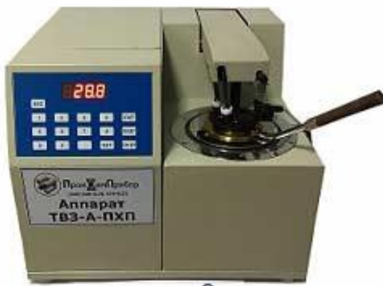
Рис. 2. Автоматический аппарат для определения температуры вспышки нефтепродуктов в закрытом тигле
