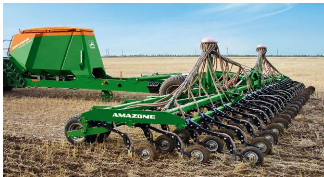
Рис. 3. Прицепная сеялка Condor 15000
