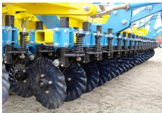
Рис.2. Сеялка прямого посева СИЧ 6.0
