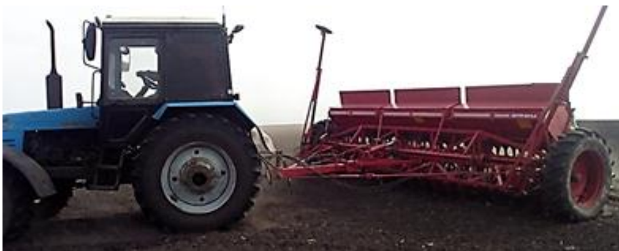
Рис. 1. Общий вид сеялки СЗ-5,4-0,6 с экспериментальными высеваящими аппаратами
