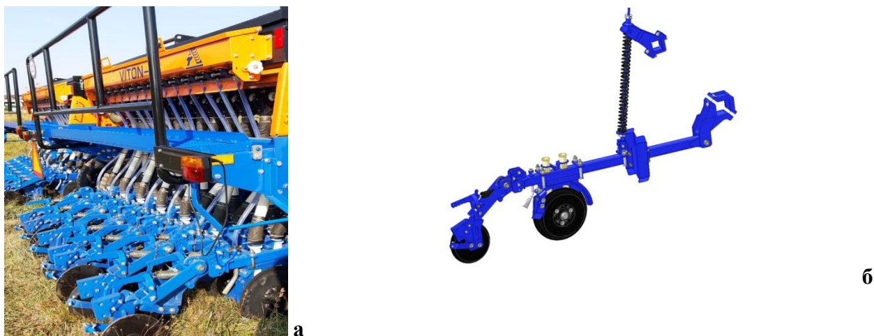
Рис.4. Зерновая сеялка прямого посева Сеялка VITON-I а – общий вид, б – сошниковая секция
