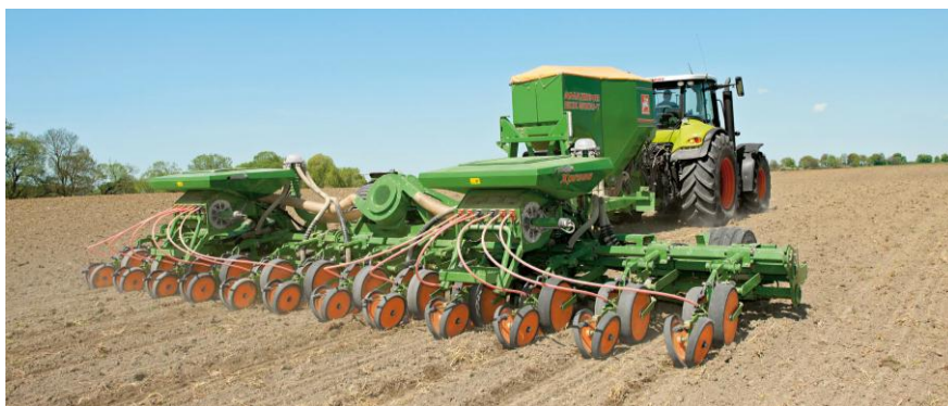
Рис. 2. Прицепная сеялка точного высева EDX 9000-ТС
