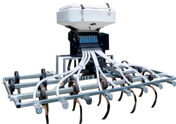
Рис.3. Электрический пневмораспределитель от SelAgro
