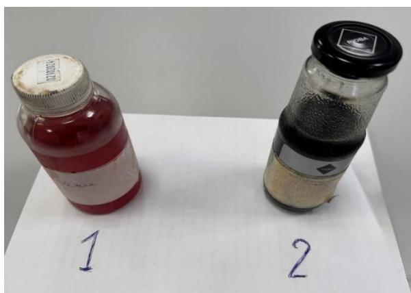
Рис.2. Пробы моторного масла: 1- представлено свежее моторное масло; 2 отработанное масло
