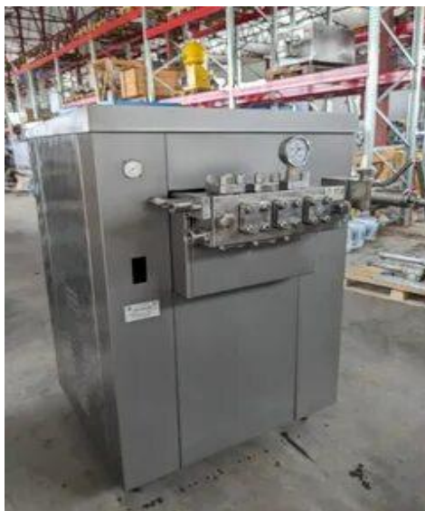
Рис. 1. Плунжерный гомогенизатор А1-ОГМ-2.5.
