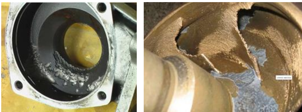
Рис. 1. Кавитационная эрозия металла
