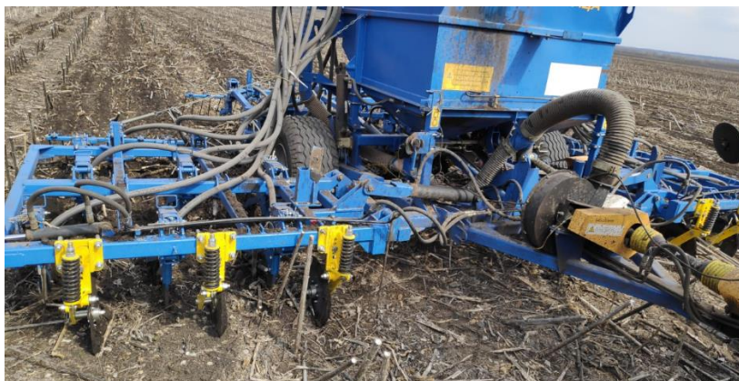
Рис. 3. Общий вид прорезающих рабочих органов, установленных на сеялки С-6ПС перед анкерными сошниками второго ряда для посева по стерне подсолнечника
