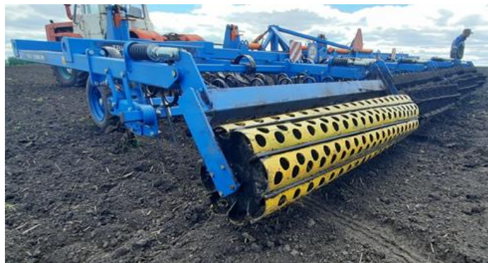
Рис. 1. Предлагаемая конструкция почвообрабатывающего катка
