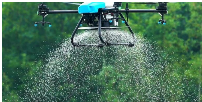
Рис. 4. Внесение минеральных удобрений при помощи БПЛА
