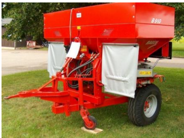
Рис. 1. Туковая сеялка с механическим распределением удобрений
