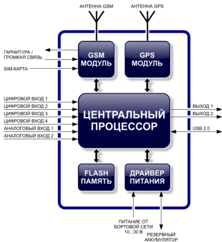
Рис. 4. Функциональная схема контроллеров системы «АвтоГРАФ-GSM»
