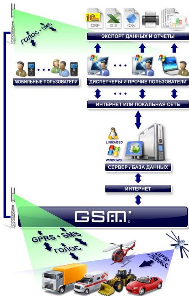
Рис. 5. Обобщенная структурная схема реализации спутникового мониторинга автотранспорта на основе АвтоГРАФ
